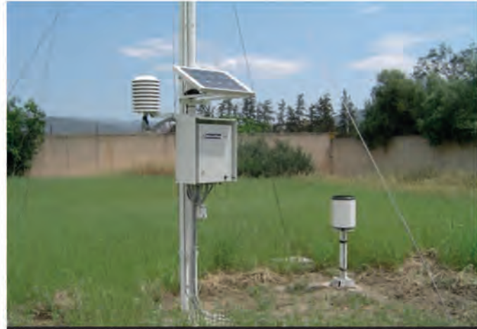
Station météorologique automatisée
